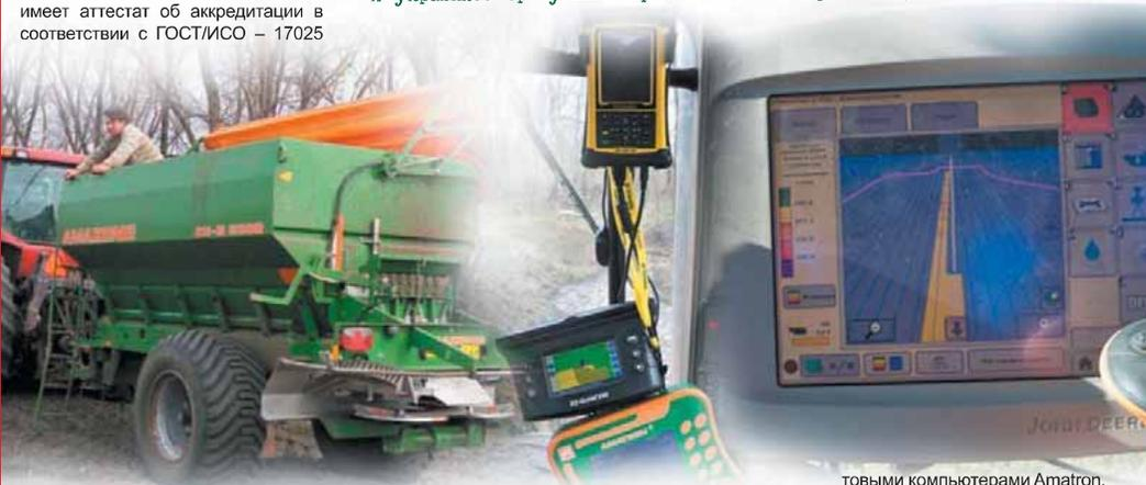
**Бортовой компьютер автоматически изменяет норму удобрений согласно карте диф. внесения, составленной в программе «Аграр-Офис».**
